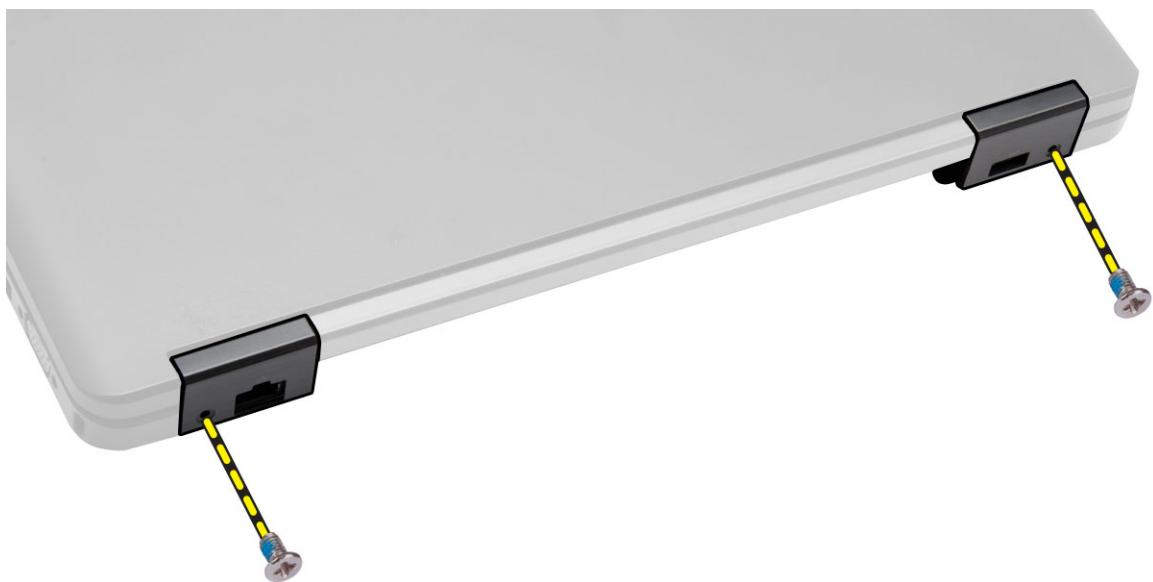
4. Uklonite zavrtnje koji učvršćuju zglob ekrana za prednji deo računara. Pritisnite i uklonite zglob ekrana iz računara.
